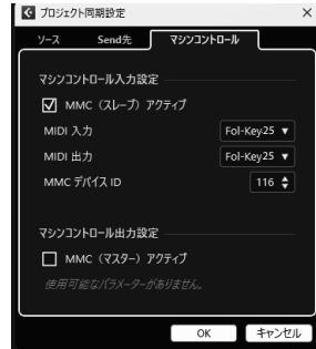
マシンコントロールのタブにある入力設定にチェックを入れ、FOL-KEY25 を選択。MMC デバイス ID を 116 に設定
